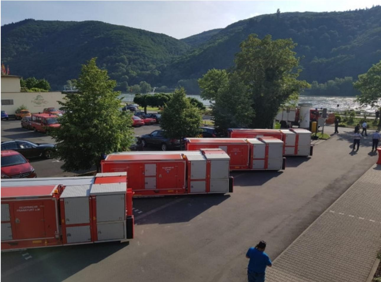
Durch die Feuerwehr Rüdesheim wurde der Einsatzzweck bei einer Übung veranschaulicht. Die Abrollbehälter dienen dazu möglichst viel Wasser von der Entnahmestelle (Fluss/See) zur Wasserabgabestelle (Einsatzstelle-Feuer) zu fördern. Eingesetzt werden die neuen Einsatzmittel, welche vom Land Hessen zur Verfügung gestellt sind, auch über die Kreis-und Landesgrenzen hinaus.
